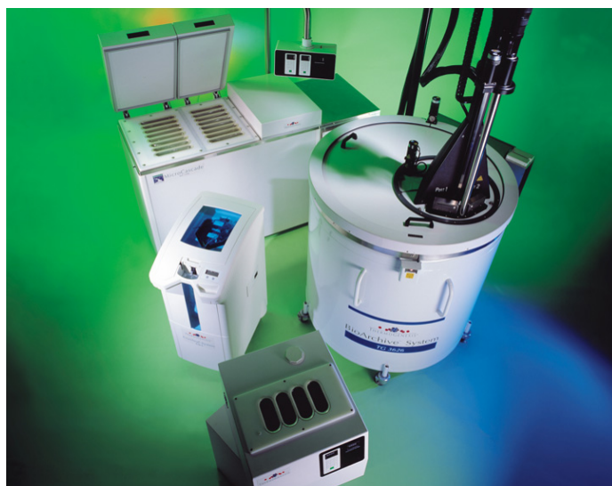
Рис. 3. Автоматизированное криогенное хранилище Bioarchive
