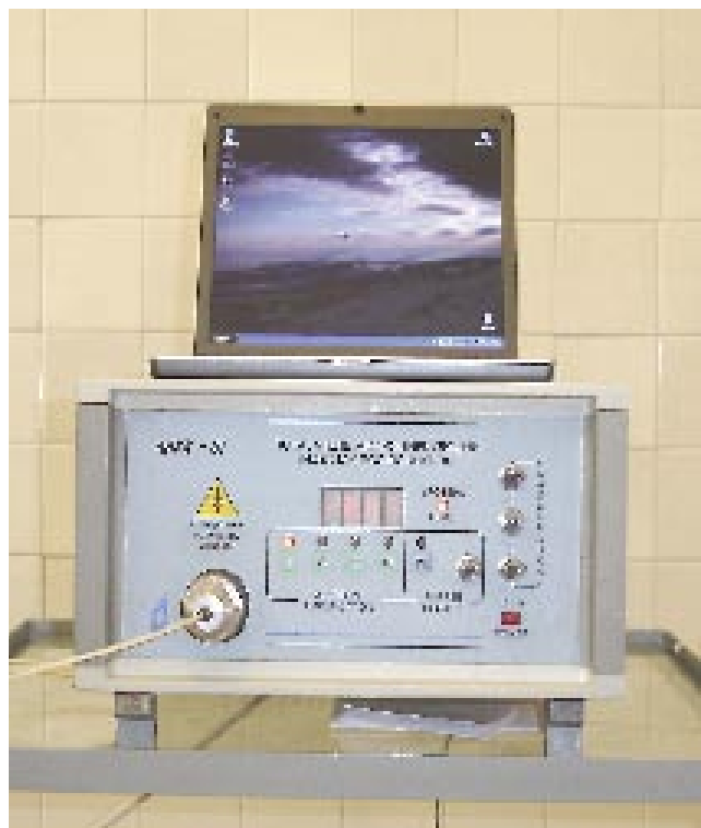
Рис. 1. Лазерный анализатор капиллярного кровотока ЛАКК-01, подключенный к персональному компьютеру
