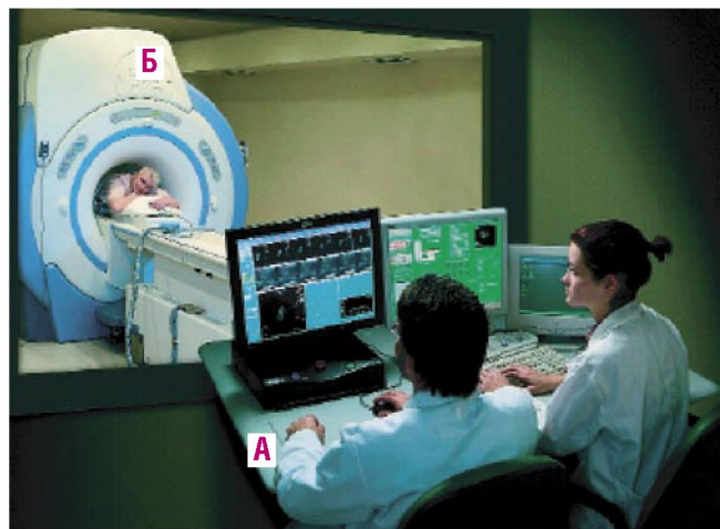
Рис. 1. Устройство системы «ExAblate». А – консоли управления, Б – электронный блок и разборный стол пациента, который одним кабелем подключен к МРТ
