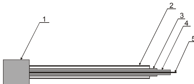
Рис. 1. Игла для СВЧ термоабляции. 1. СВЧ разъем, 2. защитный термоэкран из нержавеющей трубки, 3. внешний электрод жесткого коаксиала из нержавеющей трубки, 4. изолирующая керамическая трубка, 5. центральный электрод жесткого коаксиала
