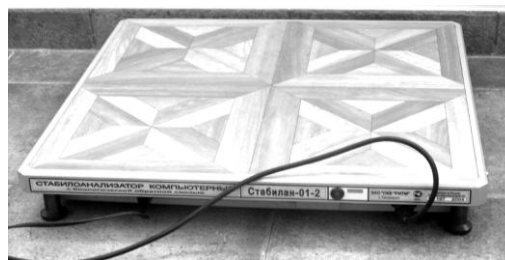
Рис 1. Компьютерный стабиланализатор с биологической обратной связью «Стабилан-01-2»
