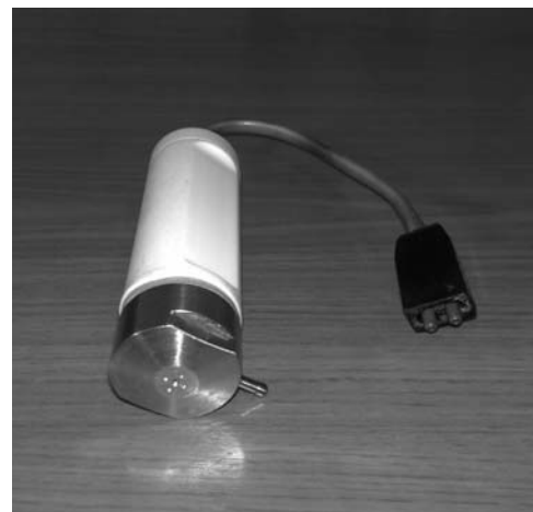
Рис. 3. Внешний вид электрогидравлического узла для дистанционной струйно-аэрозольной обработки
