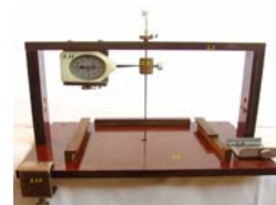
Рис. 2. Приспособление для измерения силы прокола печени.
