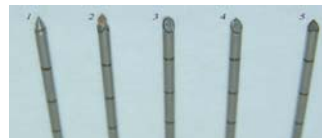
Рис. 1. Биопсийные иглы, исследованные в экспериментах. 1 - с заточкой «как карандаш»; 2 - с трехгранной заточкой; 3 - стандартная игла с односторонней заточкой; 4 - стандартной иглы с подточкой краев среза; 5 - с двугранной заточкой
