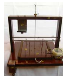
Рис. 3. Приспособление для измерения силы разрыва капсулы и паренхимы капсулы печени
