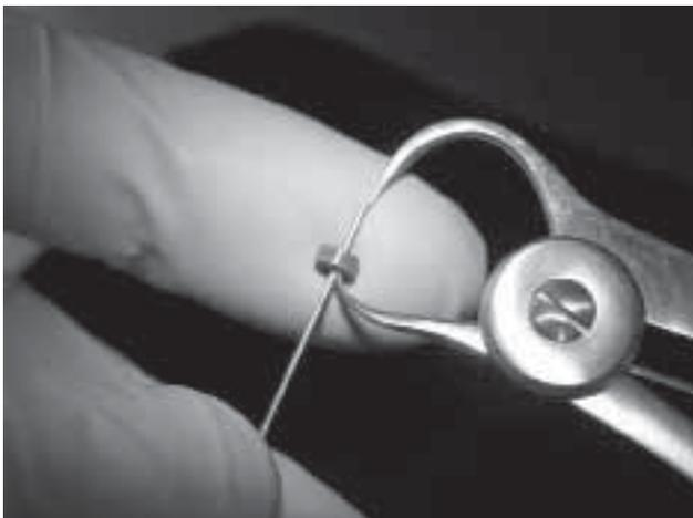
Рис. 3. Измерение зафиксированной ТТТ с помощью микрометра.
