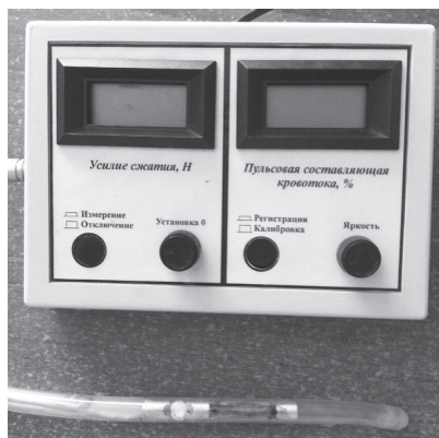
Рис. 1. Трансиллюминационный фототензометрический зонд.
