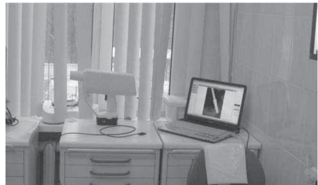
Рис. 3. Портативный рентгеновский аппарат «Пардус» позволяет выполнять исследование непосредственно во время операции стоматологической имплантации. Цифровой датчик подключен к ноутбуку со специализированным программным обеспечением.
