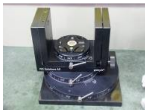
Рис. 2. Координатный стол gonyX, оперирующий данными, рассчитанными программой coDiagnostiX
