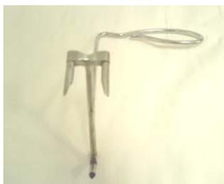
Рис. 2 Кондуктор-направитель
