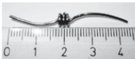
Рис. 1. Модель эндопротеза из никелида титана.
