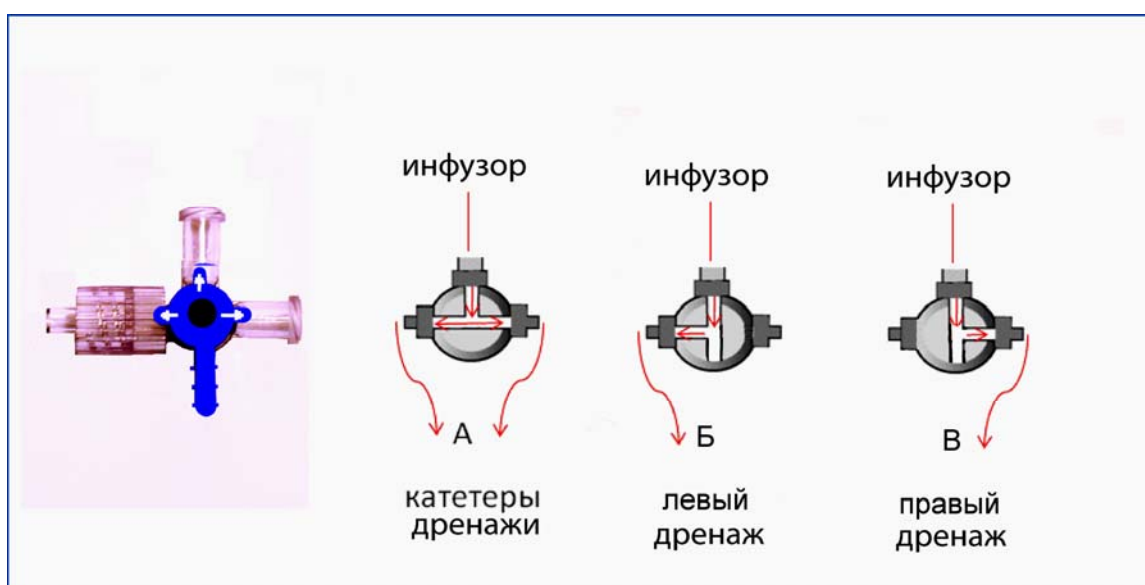
Рис.7. Схема переключення триходового крана; А- при промиванні через два дренажі, Б- при промиванні через лівий дренаж, В – при промиванні через правий дренаж
