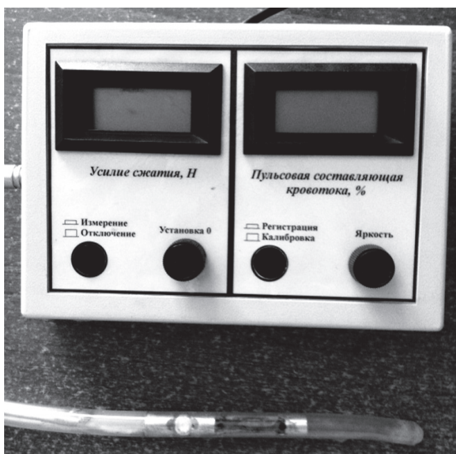
Рисунок 1. Трансиллюминационный фототензометрический зонд
