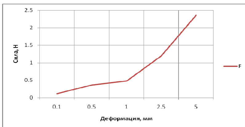
Рис. 2. Значение силы давления аппарата в зависимости от деформации в области регуляторов дозированной нагрузки аппарата
