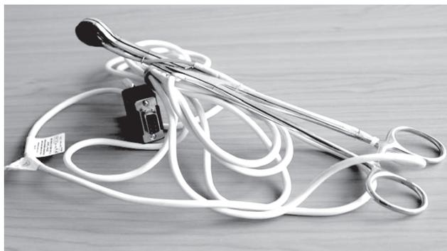
Рис. 1. Модифицированный зажим с фотоплетизмографическими датчиками пульсоксиметра
