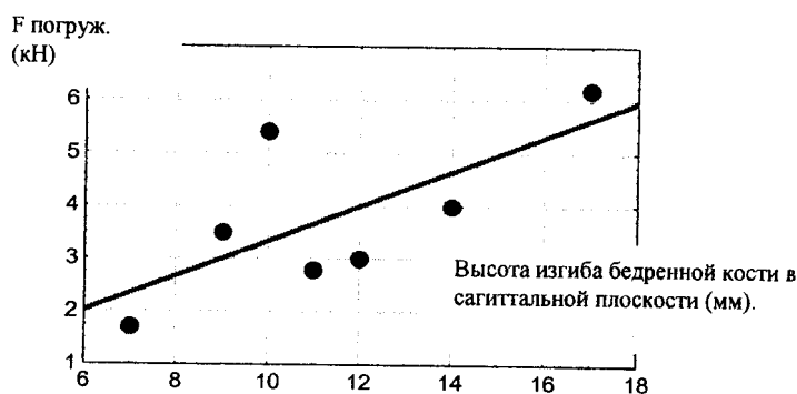
Рис. 4. Зависимость прочности фиксации ножки МАТИ-ЦИТО ( F_p ) от кривизны кости (уровень резекции 120 мм).
