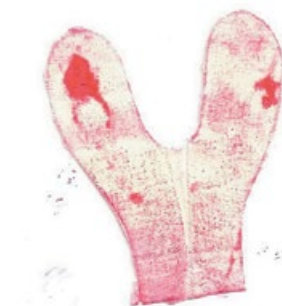
Рис. 2б. Сканер контактов на копировальной бумаге
