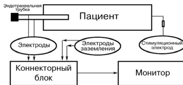
Схема соединения пациента с комплексом электрофизиологической аппаратуры для мониторинга нейрорегулирующих структур.
