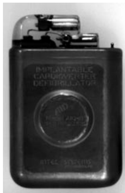
Рис. 1. Одна из первых моделей ИКД (объем – 150 см³).
