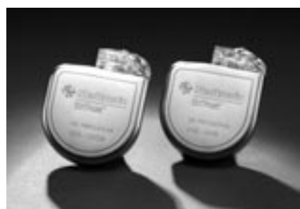
Рис. 2. Современные ИКД – двухкамерный и однокамерный (36 см³, масса 75 г, закругленный корпус, энергия шока – 35 Дж, программируемый активный корпус).
