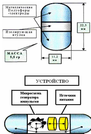
Рис. Схема АЭС ЖКТ
