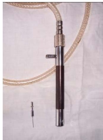
Рис. 2. Рукоятка со сменным наконечником и клапаном регулирования подачи газа
