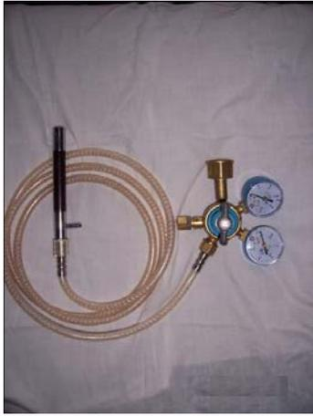
Рис. 3. Пневмопровод с редуктором
