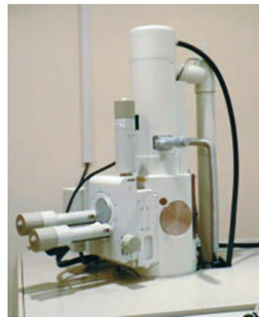
Рис. 1. Сканирующий электронный микроскоп JSM 6390LV, Jeol
