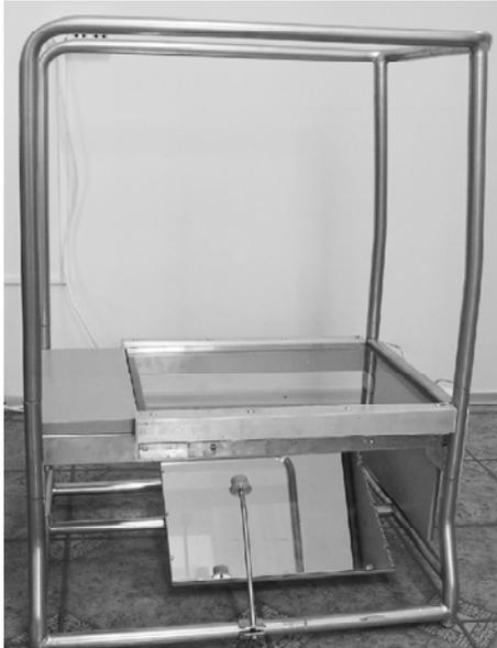
Рис. 1. Оптический плантограф
