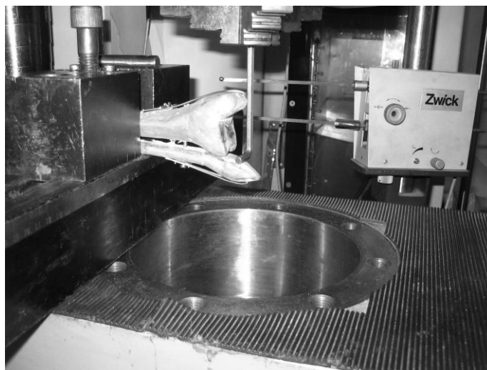
Рис. 2. Фиксация модели дистального отдела костей голени в патроне испытательной машины.
