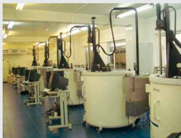
Рис. 2. Роботизированные криокомплексы «BioArchive®», ThermoGenesis, USA в ГУЗ «БСК ДЗМ»
