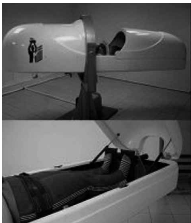
Рис. 1. Стенд искусственной силы тяжести «Салют» (центрифуга короткого радиуса действия)
