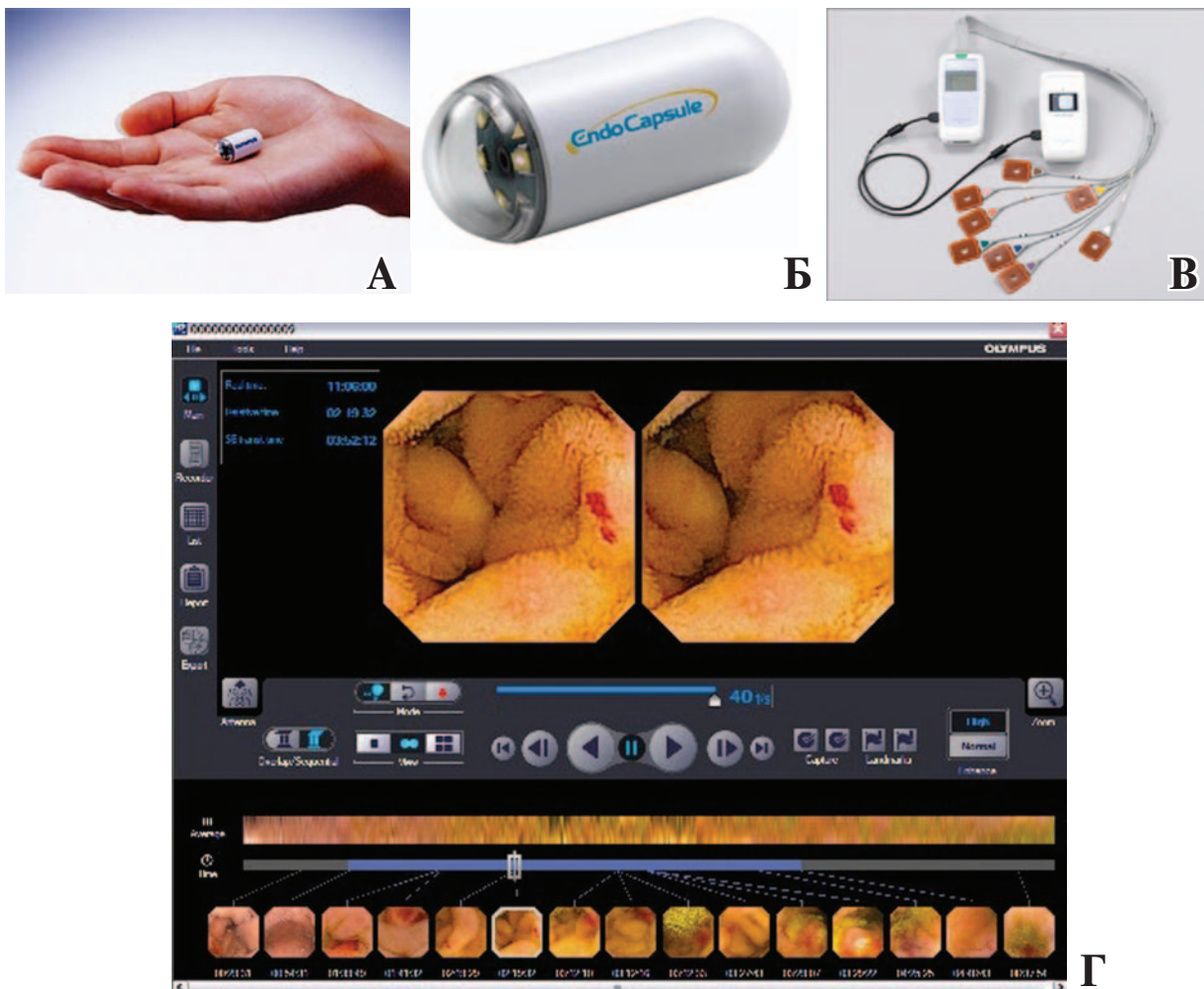
Рис. 1. А – вид эндоскопулы, Б – эндоскопула, В – записывающее устройство с присоединяемыми внешними антеннами и устройство просмотра в реальном времени, Г – вид окна рабочей станции для просмотра и интерпретации изображений
