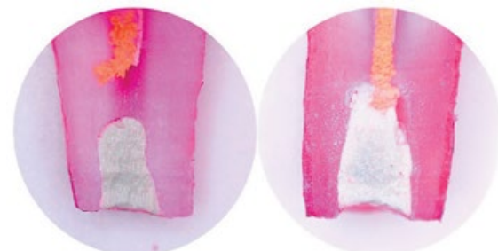
Рис. 2. Шлиф зуба после испытаний на краевую проницаемость материала «MTA Pro Root». Отсутствует проникновение красителя внутрь пломбировочного материала и по границе
