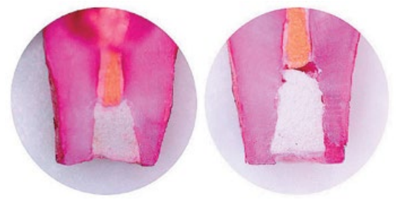
Рис. 3. Шлиф зуба после испытаний на краевую проницаемость материала «Рудент». Краситель проник внутрь пломбировочного материала. Незначительное проникновение красителя по границе
