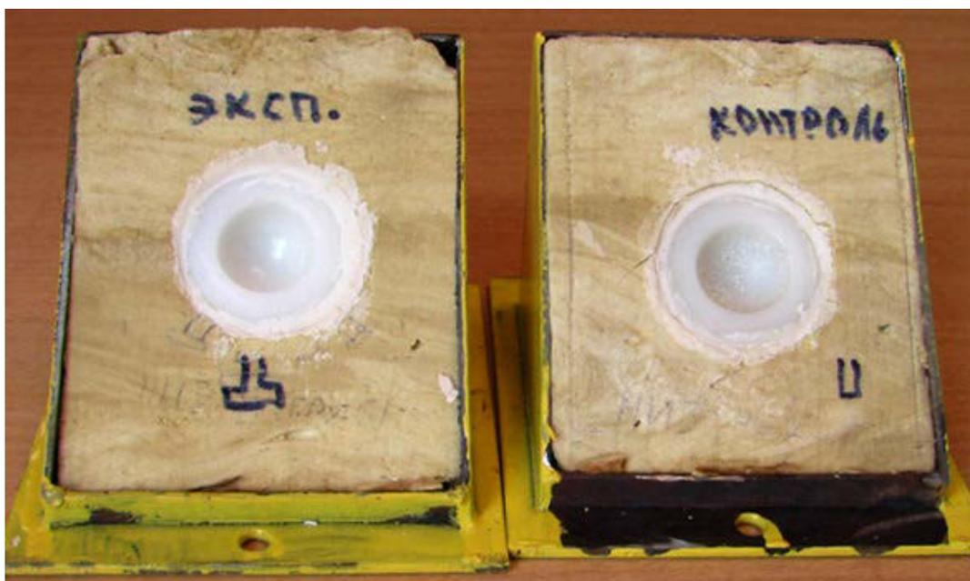
Рисунок 1. Внешний вид полиэтиленового блока, помещенного в оснастку.
