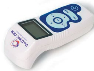
Рис. 1. Стимулятор ДЭНС для проведения нейроэлектростимуляции жевательных и мимических мышц
