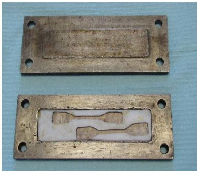
Рис. 2. Стальная пресс-форма с фторопластовым разделением для приготовления образцов
