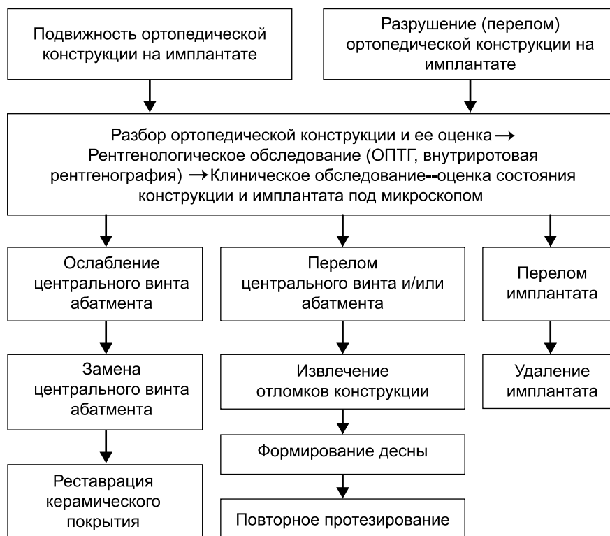
Рис. 10. Схема алгоритма врачебных действий по устранению осложнений, связанных с ослаблением и переломами центральных винтов в имплантатах.
