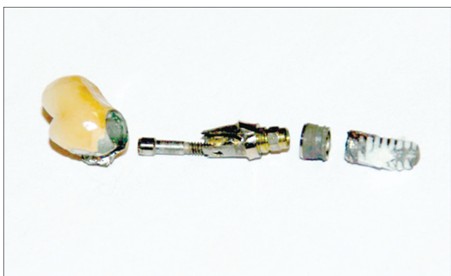
Рис. 7. Перелом центральных винтов и шеек имплантатов.
