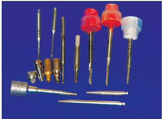
Рис. 4. Набор для центриции вращательных инструментов при удалении обломка центрального винта двухэтапного стоматологического имплантата.
