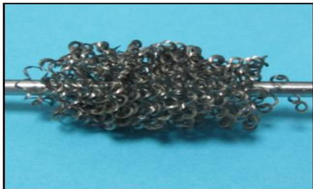
Рис. 2. Укладка проволочной спирали (заготовка готова к прессованию)
