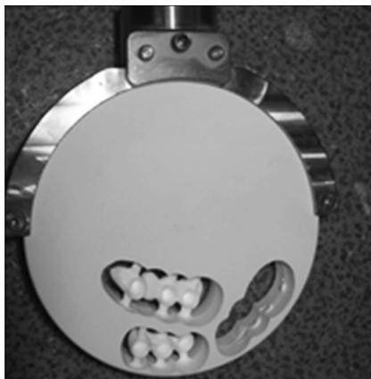
Рис. 8. Вид конструкции на основе диоксида циркония после этапа фрезерования (блок размером 90×16 мм).
