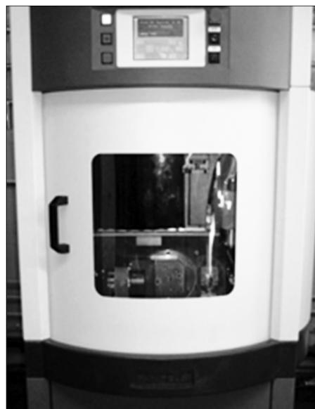
Рис. 7. Фрезерующий блок CAD/CAM-системы Hint-El's.
