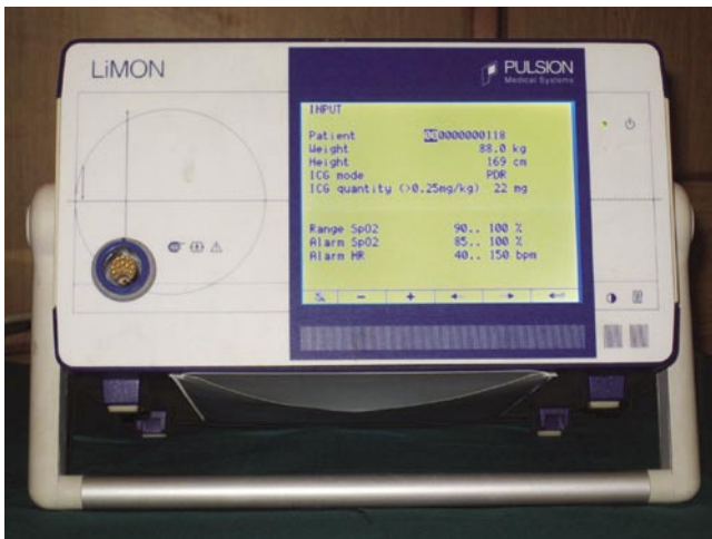
Рис. 1. Неинвазивный монитор для оценки функционального состояния печени LiMON PC5000, PULSION Medical Systems AG (Германия)
