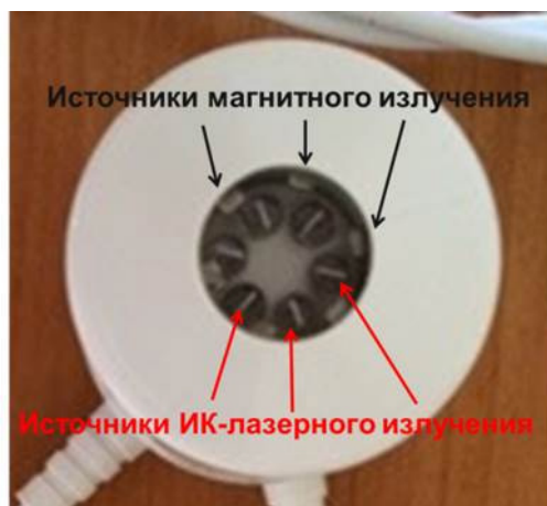
Рис. 1. Излучатель с источниками бегущего магнитного и инфракрасного лазерного излучения
