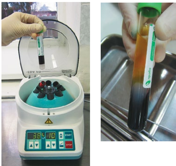
Рис. 5, 6. Центрифуга EBA 20 и полученная в результате центрифугирования плазма
