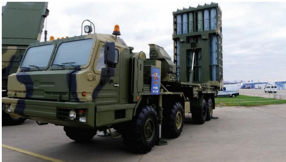
Sistem se zasniva na šasijama tri BAZ-ova vozila točkaša i to: kamionskoj 6x6 konfiguraciji za višefunkcionalni radar 50N6E i kontrolnu stanicu 50K6E, do je kao šasija za 12-cevne lansere raketa 50P6E poslužila platforma 8x8 (na slici).
