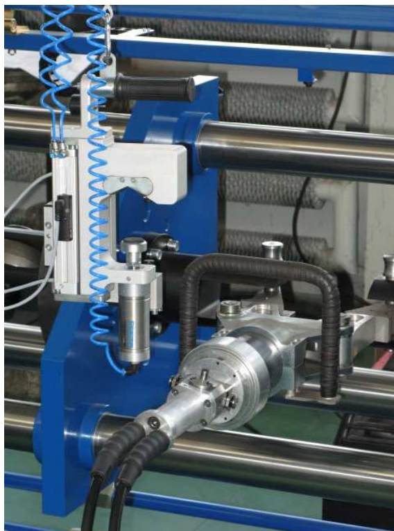
Ryc. 5. Manipulator zamontowany w stanowisku do badania hydraulicznych narzędzi ratowniczych.
