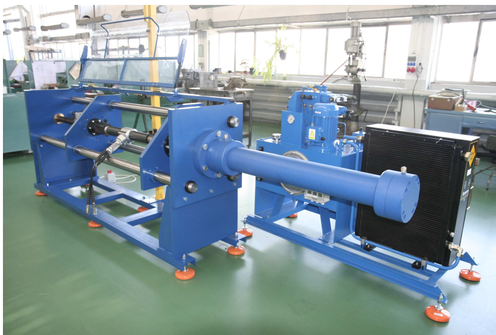
Fot. 1. Stanowisko do badania hydraulicznych narzędzi ratowniczych
