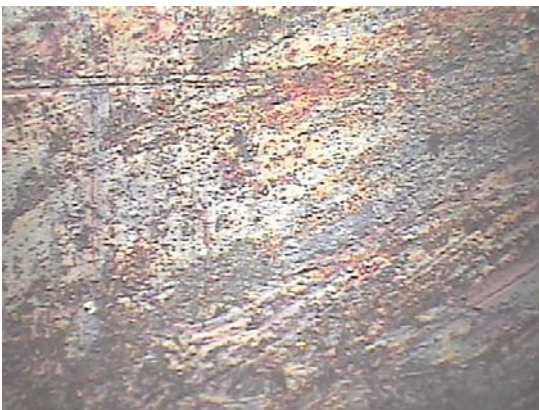
а) б) Фото 2. Внешний вид среза, обработанного Сил энд Протек в начале (а) и в конце (б) эксперимента (II группа). Изображение получено с помощью светового микроскопа с увеличением x200.
