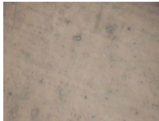
а) б) Фото 2. Внешний вид среза, обработанного Сил энд Протек в начале (а) и в конце (б) эксперимента (II группа). Изображение получено с помощью светового микроскопа с увеличением x200.
