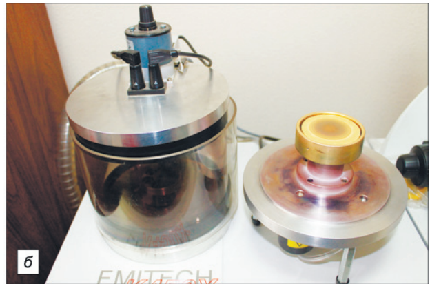
Рис. 1. Аналитический комплекс SEM Mira/LMU, TESCAN (а) и напылительная установка EMITECH K450X (б).
