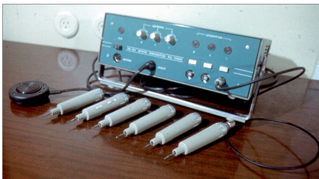
Рис. 1. Ультразвуковой аппарат для микрохирургии глаза УЗХ-Ф-9102-ОФ "МЕДЭЛ" с 6 сменными ультразвуковыми насадками (микроскальпель, круглый нож, брюшистый скальпель, аппликатор, игла, костная пила).
