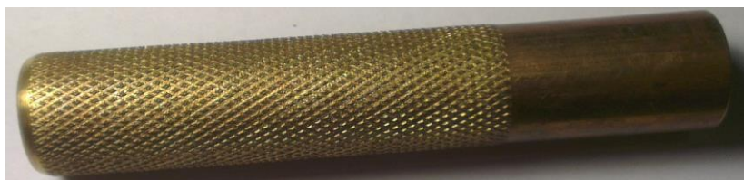
Рис. 5. Електрод з напівжорсткою поверхнею та діаметром 15 мм
