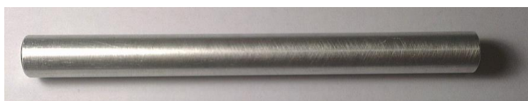
Рис. 2. Алюмінієвий електрод з гладкою поверхнею та діаметром 10 мм
