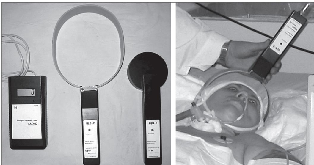
Рис. 1. Внешний вид прибора АДО-03. Измерение индекса тотальной диэлектрической проницаемости.
