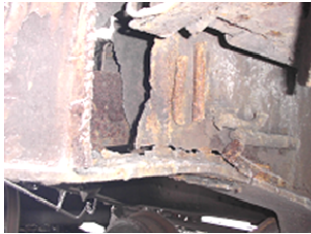
Рис. 6. Відрив вертикального листа шворневої балки від стійки
